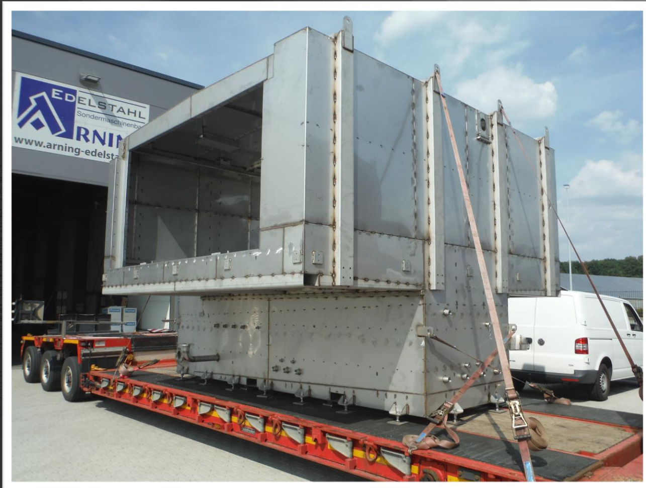
Gehäusebau aus Edelstahl 1.4571
