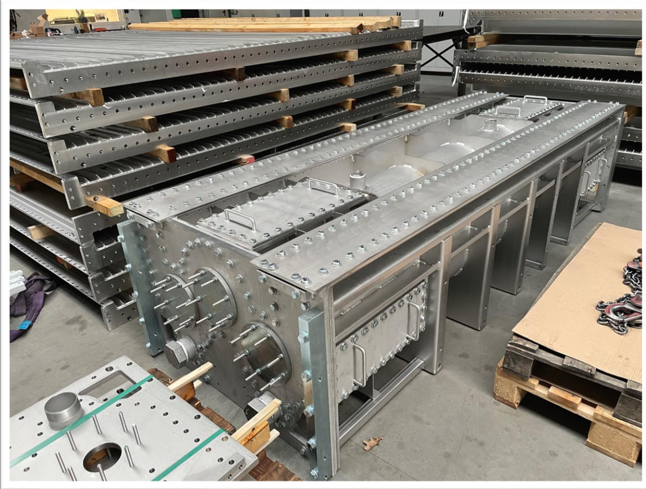
Druckkammer & Umlenkgetriebe aus Edelstahl
