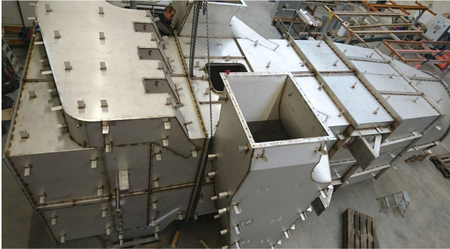
Anlagenbau aus Edelstahl 1.4828 bis 1050°C
