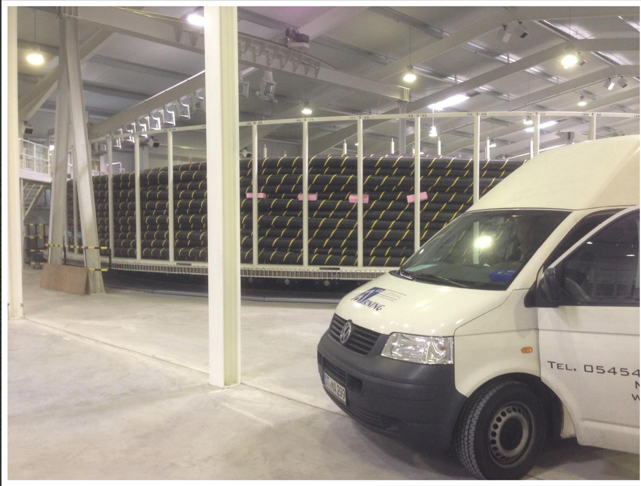
Fördertechnik Seekabelaufwicklung bis 7000 Tonnen
