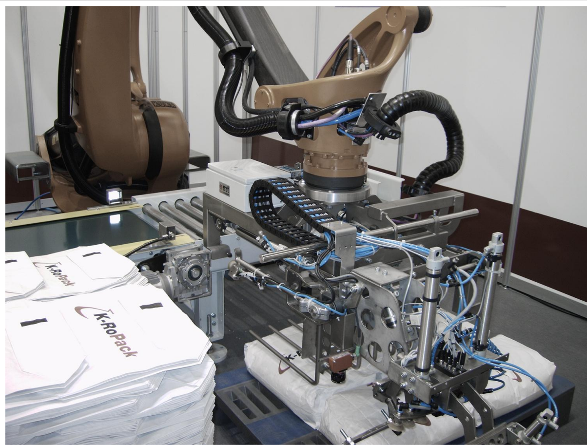
Greifer für die Sack- Befüllung
